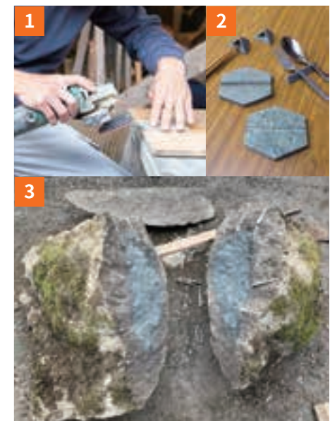
1 日向石の加工作業。研磨技術の進化で、これまでにない仕上がりに。 2 企画中の製品たち。大山や大山こまをモチーフにした箸置き、コースターなど。 3 割った直後の日向石。中央の青い部分は時間が経つと、青灰色に変化。
